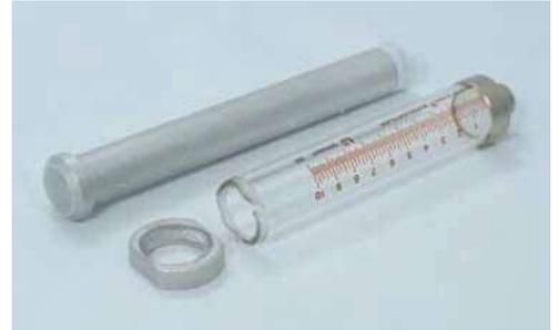
麻酔器の圧力で破損したシリンジ
