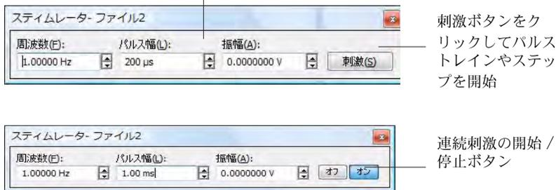
PowerLab のフロントパネルの出力端子と入力チャンネル端子とを BNC ケーブル (PowerLab の付属品として供給される) で接続すれば、PowerLab のスティムレータを使って実験ができます。その際、予想される刺激の最大出力を想定し、それに対応するように入力チャンネルのゲインレンジを合わせる必要があります。シグナルが大きすぎてスケールオーバーにならないように、また表示できない程小さ過ぎないように十分考慮して入力レンジを決めて下さい。
