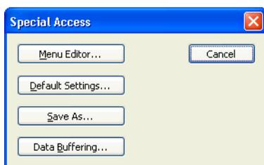
隠れているコマンドメニューを再表示させたい場合は **Menu Editor** (メニューエディタ) ボタンをクリックしてメニューダイアログを呼び出し、隠されているコマンドメニューのロックを外して表示させます。ロックしたり隠して取り除いたものを元に戻したい時は、このダイアログにアクセスして下さい。
