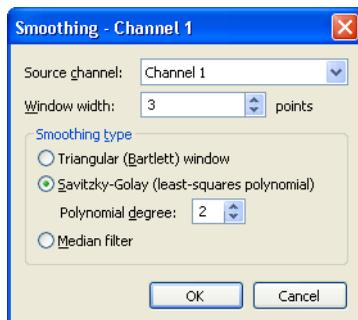
通常のチャンネル演算と同様に、**Source channel**(ソースチャンネル) ドロップダウンリストからソースチャンネルを指定します。
