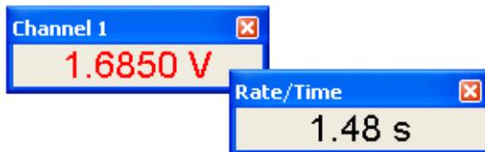
DVM ミニウィンドウは現行のアクティブウィンドウの前に浮動表示します。そのタイトルバーをドラッグすると、どの場所にも移動します (LabChart アプリケーションウィンドウの枠以外にも)。クローズボックスをクリックするとウィンドウは消えます。ミニウィンドウの外枠をドラッグするとサイズが変更できます。ミニウィンドウの大きさを変えると表示テキストの大きさも変わるので、読み取り易い大きさにウィンドウのサイズを調節して下さい。表示テキストの色は同じチャンネルのデータトレースと同色になりますので判別が簡単です。ミニウィンドウのタイトルバーには対応しているチャンネル数が表示します。デフォルトタイトル (Channel 1 などの) でチャンネルをリスト表示しますが、チャンネルセッティングのダイアログでチャンネル名を変更するとそれに対応して変わります。チャンネル名は **DVM** サブメニューにも同様に変更が反映されます。
