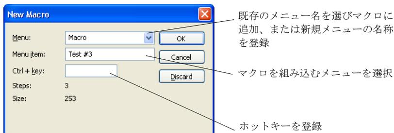
**Menu**(メニュー) ドロップダウンリストから、作成したマクロを表示させるメニューを選択します。デフォルト設定では、作成したマクロはマクロメニューに新規コマンドメニューとして追加されます。テキストエントリーにタイトル (10 文字以内) を入力すると、新しいメニューが作成できます。このメニューはメニューバーの中の LabChar メニューの右、ヘルプメニューの左側に追加されます。マクロの名前 (20 文字以内) を **Menu item**(メニュー項目) ラベル欄に入力します。各マクロ名はユニークな (専用の) 名称を使ってください。
