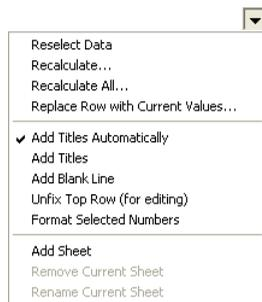
ウィンドウ右のドロップダウンリストには、レイアウトや選択範囲を管理する幾つかのコマンドが付いています。**Reselect Data**（データの再選択）、**Recalculate**（再計算）...、**Recalculate All**（すべてを再計算）... コマンドは後で説明（“ソースデータ”152 ページ参照）します。データ行を選択し **Replace Row with Current Values**（行を現在のデータに置き換える）... を選ぶと、データパッドの表記列ヘッダーに基づいて演算され表示したその行の数値が、現在の選択範囲やアクティブポイントを反映した数値に置き換わります。これによってデータを再選択したり**選択範囲設定...** コマンドで選択範囲を調整すると、データ行は更新した数値に置き換わります。
