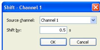
通常のチャンネル演算と同様に **Source channel** (ソースチャンネル) ドロップダウンリストからソースチャンネルを指定します。
